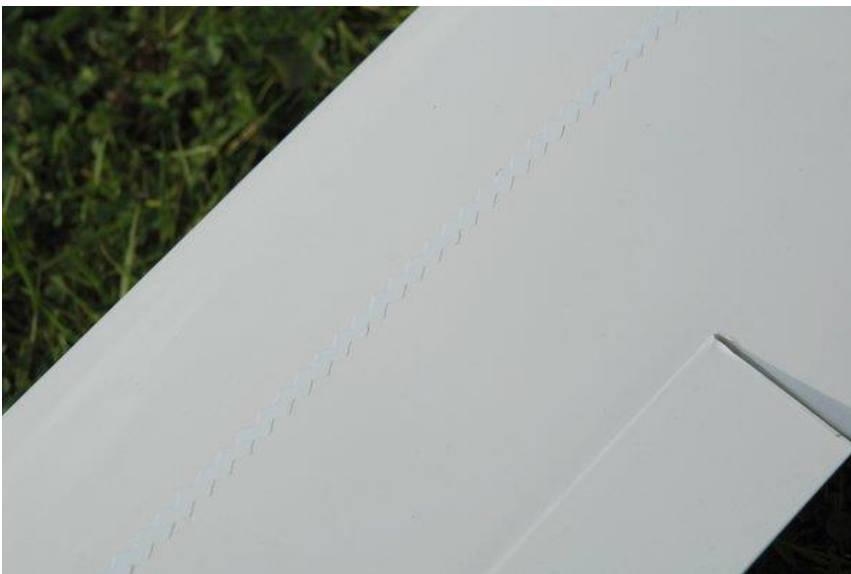
Fig. 91 : exemple de turbulateur zigzag sur une aile de DG1000
