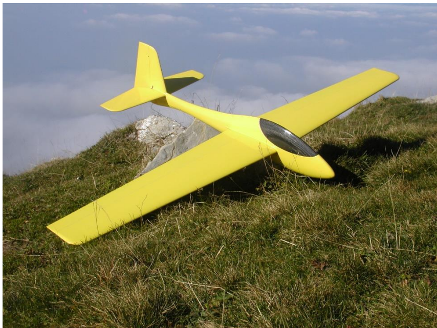
Le Wasabi est un planeur de voltige, conçu par Thierry Platon, Jérôme Bobin et François Lorrain, qui bénéficie d'une étude poussée du fuselage pour les phases de vol tranche (photo Jérôme Bobin).
