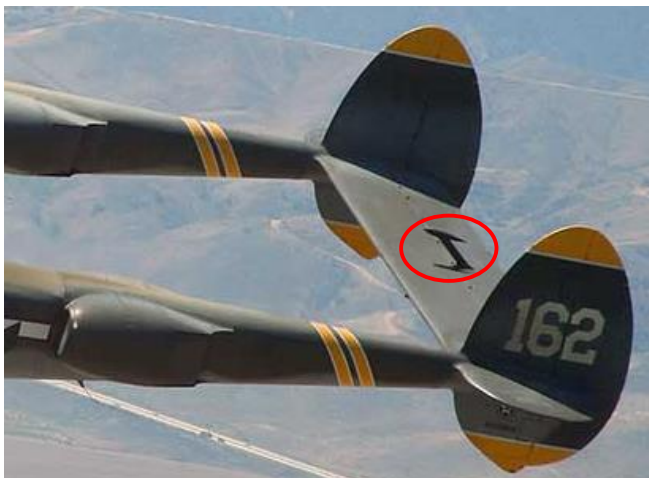
Fig. 109, masse anti-flutter (gouverne de profondeur, Lockheed P38).
