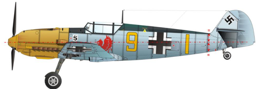
Fig. 78, matérialisation (trait en rouge) de l'axe médian du fuselage.
